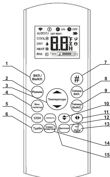
**1 - Кнопка ВКЛ./ВЫКЛ.** Кнопка вкл./выкл. предназначена для включения и выключения кондиционера
